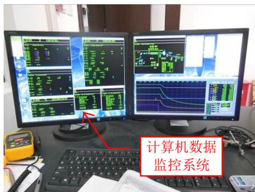
照片 4-24 离子注入机操作台及操作界面
